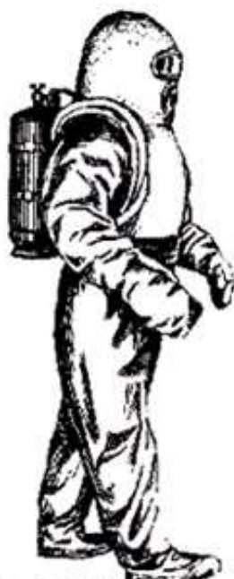
Рис. 3.53. Газотеплозащитный костюм для горноспасателей. Изобретение Г.С.Альтшуллера а.с. № 111 144
